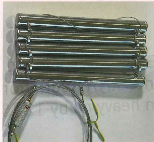
SUS304 製イオン電極(1本で油30ℓ対応)
